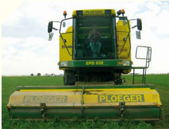
3 EPD 538 met een 5 meter breed nieuw model plukelement zonder grondrol
