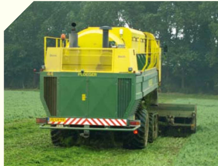
4 630 mm brede rupsen en het 5 meter brede nieuw model plukelement
