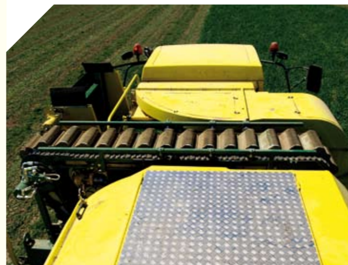
1 Nieuw model bakjes elevator met grotere inhoud bakjes, een 34% verbrede peulenband en afzuig systeem
